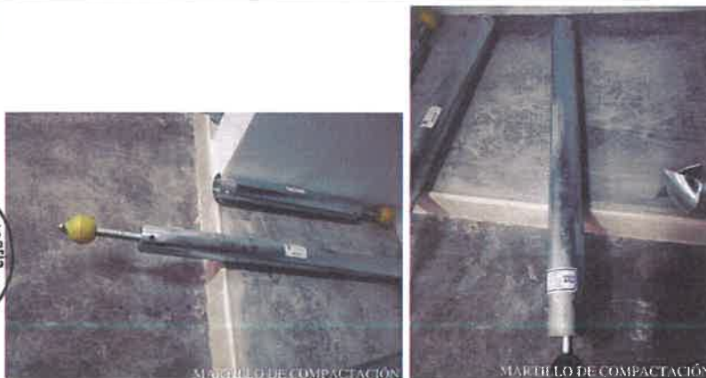
Foto 04: Martillos de compactación proctor
